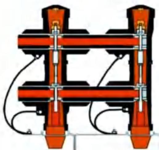
Рисунок 5 - Сборные шины на 1600 А, 2000 А, 2500 А
