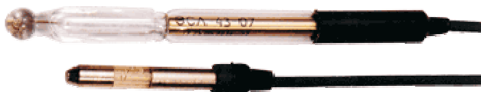
Рисунок 1 – Общий вид электродов стеклянных лабораторных ЭСЛ-43-07, ЭСЛ-63-07
