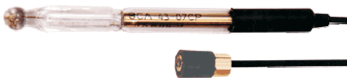
Рисунок 2 – Общий вид электродов стеклянных лабораторных ЭСЛ-43-07СР, ЭСЛ-63-07СР
