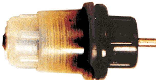
Рисунок 1 – Общий вид электрода хлорсеребряного выносного ЭХСВ-1
