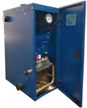
длительном и эффективном сжигании природного газа с помощью газогорелочных устройств, снабженных автоматическим регулированием и контролем безопасности работы.
