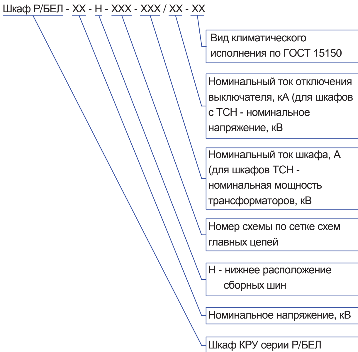
Рисунок 1 - Структура условного обозначения шкафов КРУ при заказе
