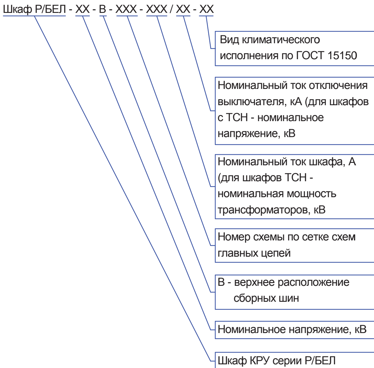
Рисунок 1 - Структура условного обозначения шкафов КРУ при заказе
