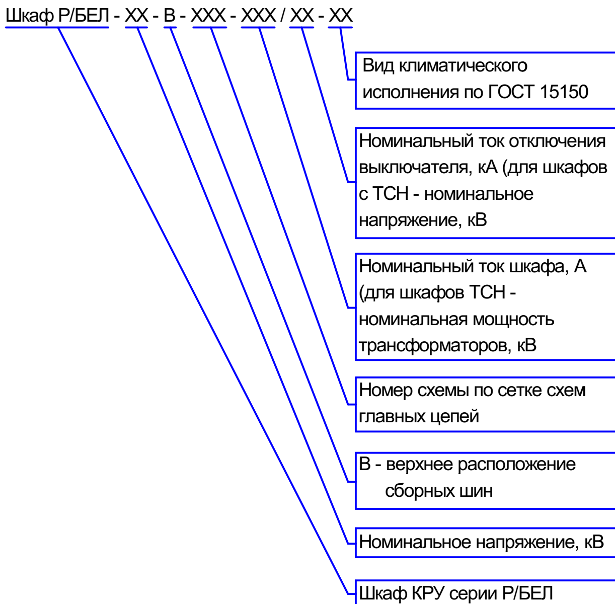
Рисунок 1 - Структура условного обозначения шкафов КРУ при заказе
