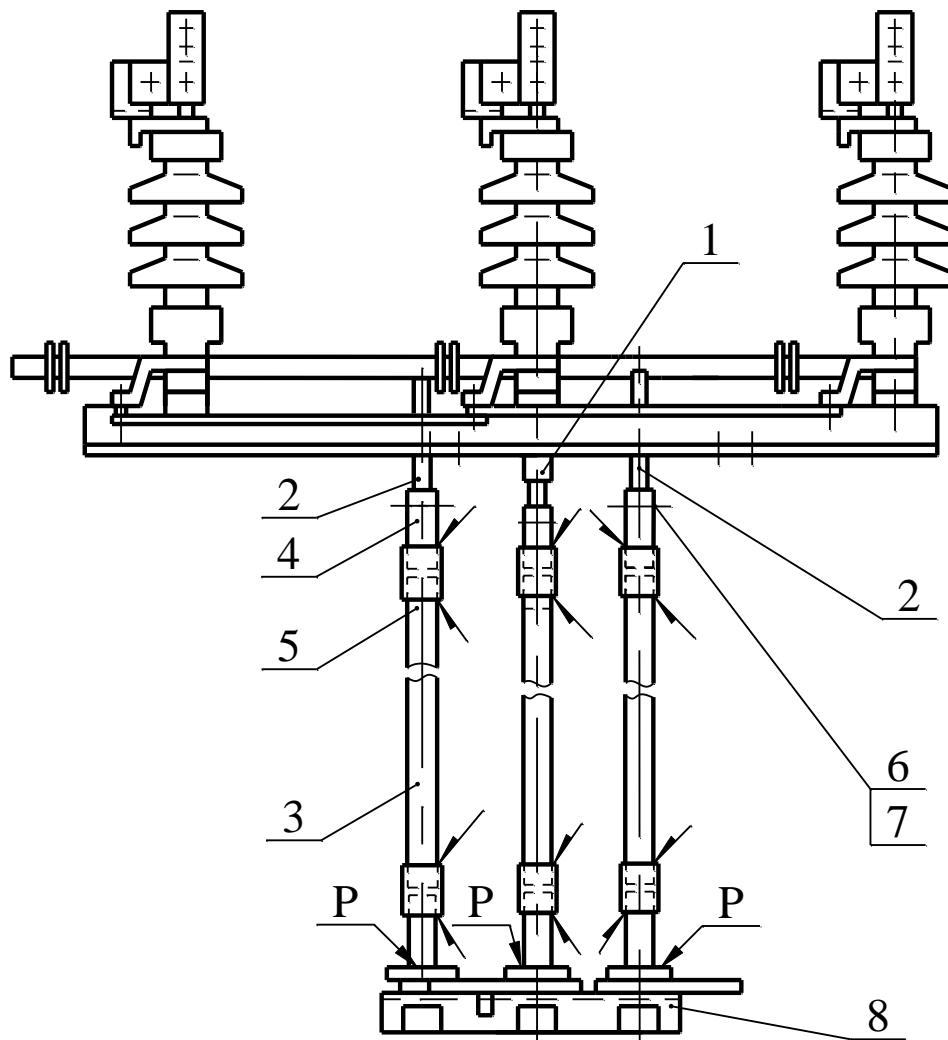
Места сварки зачистить от цинкового покрытия напильником.
