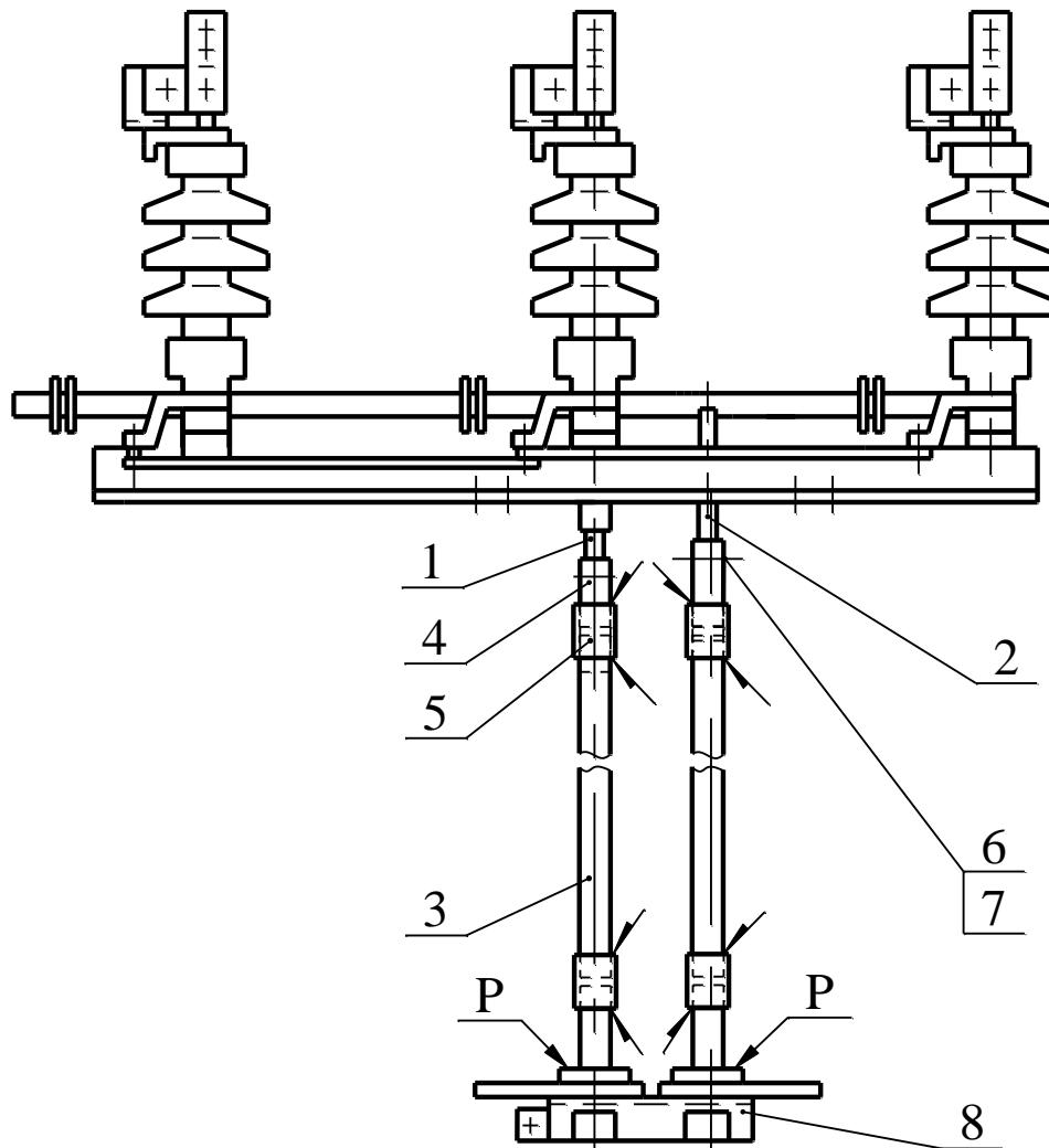
Места сварки зачистить от цинкового покрытия напильником.
