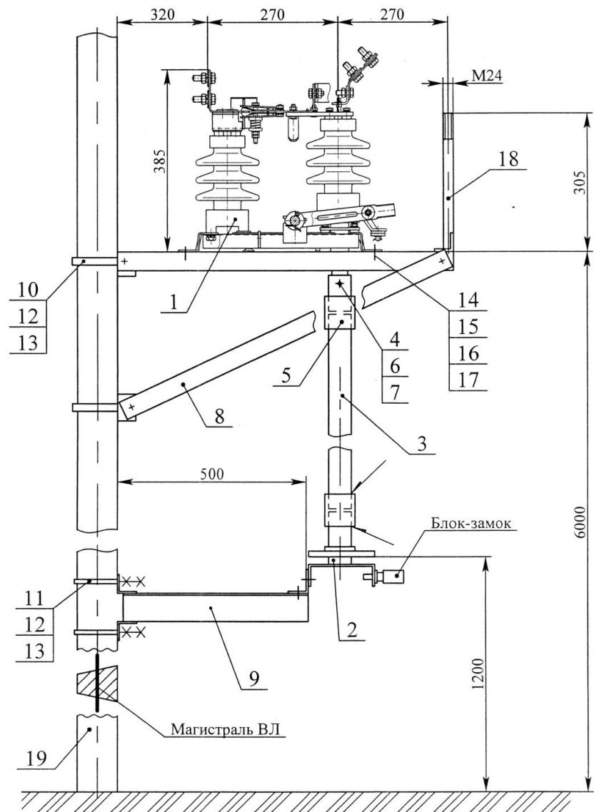
1- разъединитель; 2- привод, 3-труба 25х3,2; 4- трубка из комплекта GHYP с наружным диаметром 33,5 мм.; 5- трубка-муфта из комплекта ПРНЗ; 6- ось, 7- шплинт из комплекта ПРНЗ; 8 – кронштейн разъединителя; 9- кронштейн привода; 10- хомут кронштейна разъединителя; 11- хомут кронштейна привода; 12- гайка М16; 13- шайба 16; 14 – болт М12; 15- гайка М12; 16- шайба 12.65Г; 17- шайба 12; 18 – траверса; 19- опора типа СВ-110-35
