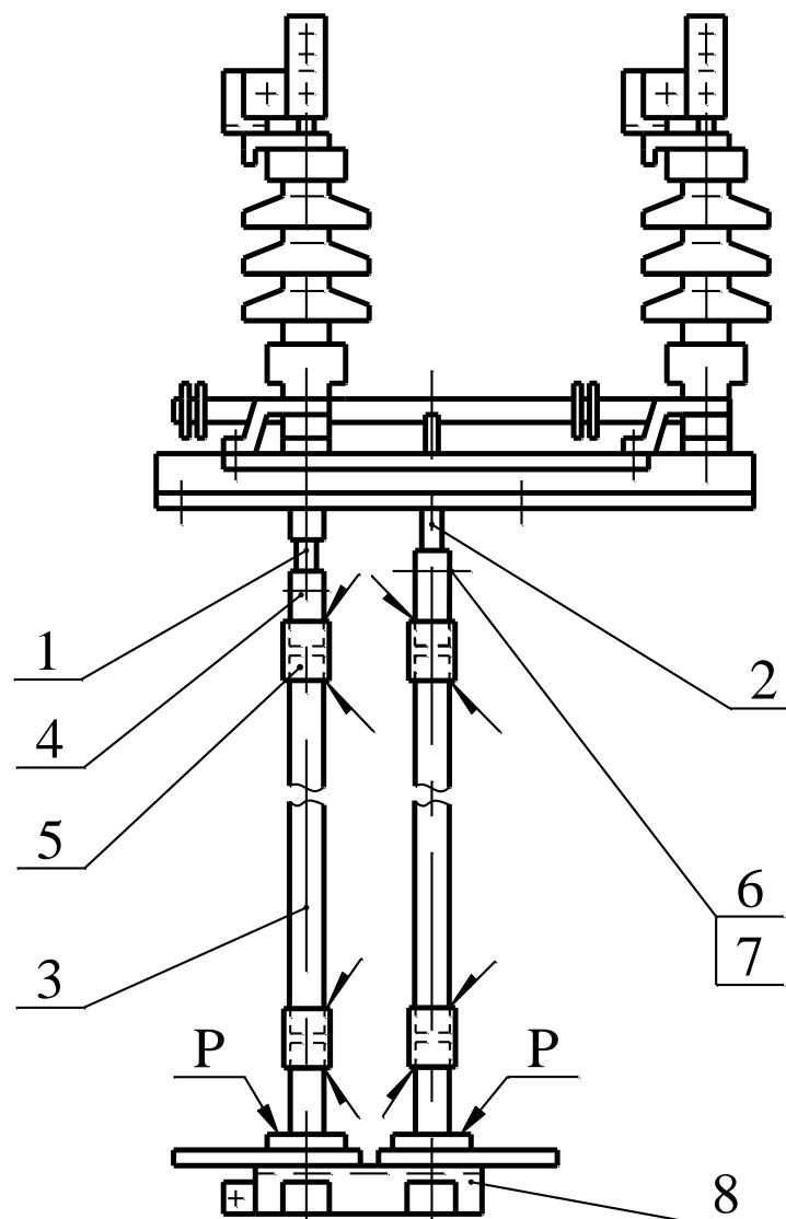
Места сварки зачистить от цинкового покрытия напильником.
