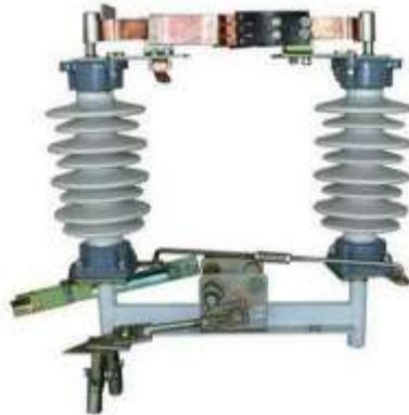
Разъединители РДЗ изготавливаются из отдельных полюсов, которые могут соединяться в один однополюсный, двухполюсный или трехполюсный аппарат, устанавливаемый на горизонтальной плоскости.
