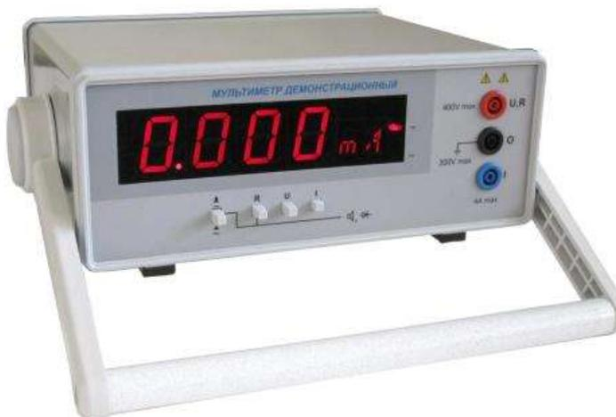
Принцип действия мультиметра основан на преобразовании измеряемой величины в нормированное постоянное напряжение с последующим его измерением аналого-цифровым преобразователем (АЦП) интегрирующего типа.
