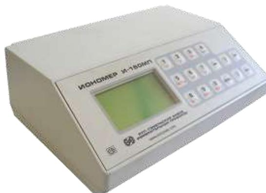
Микропроцессорный иономер И-160.1МП с функцией потенциометрического титрования используется для определения щелочного числа в маслах по ГОСТ11362-96 (ИСО-6619-88) «Нефтепродукты и смазочные материалы. Число нейтрализации. Метод потенциометрического титрования» и предназначен для определения в водных растворах активности ионов водорода (рН), окислительно-восстановительного потенциала (Еh), активности и концентрации ионов:
